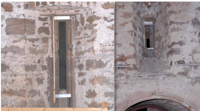
Abb. 2: Links die Lichtschranke in der hofseitigen Öffnung, rechts die Lichtschranke in der Öffnung über der Eingangstür.
