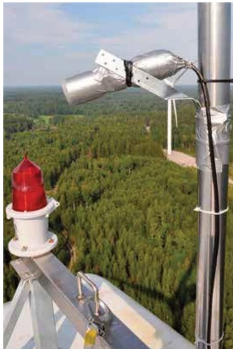
Mikrofon über der Gondel, installiert für eine automatische Fledermausdetektor-Untersuchung.
