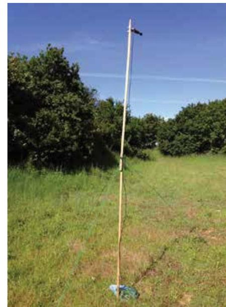
Automatischer Fledermaus-Detektor auf Bodenniveau an einem geplanten Standort von Windkraftanlagen. © J. Sudraud
