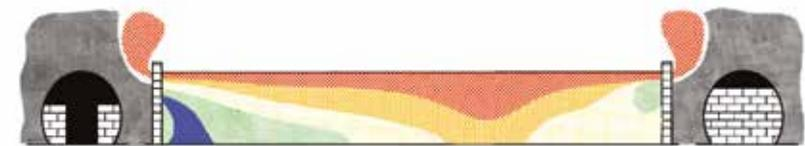
Optimum, mit recht stabilen, weit reichenden Temperaturspannen und guten Feuchtigkeitsverhältnissen. Optimales Ausmaß des Verschlusses abhängig von Tunnellänge.
